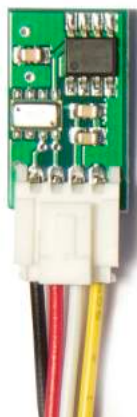
Abbildung 2: Externes Sensorboard (Temperatur / Luftdruck / Luftfeuchtigkeit)
