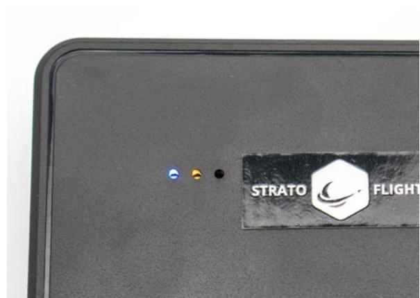
Nach dem Einsetzen der SIM-Karte und Einschalten des STRATOfinders initialisiert sich der GPS-Tracker und sucht nach GPS-Satelliten und stellt parallel eine Verbindung zum Mobilfunknetz für die Datenübertragung her. Damit der GPS-Tracker für die Initialisierung eine Verbindung zu den GPS-Satelliten herstellen kann, gehe mit dem GPS-Tracker am besten nach draußen und lasse diesen ein paar Minuten unter freiem Himmel liegen, sodass dieser eine Verbindung aufbauen kann.
