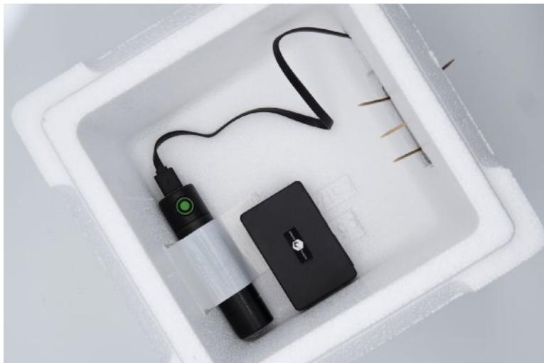
Dies kannst du auf der Unterseite des STRATOfinders befestigen und auf dem Boden der Styroporsonde fixieren. Achte darauf, dass das Stratoflights Logo auf dem Deckel des STRATOfinders in Richtung Himmel zeigt, da sich hierunter die GPS-Antenne befindet und somit optimaler Empfang besteht.
