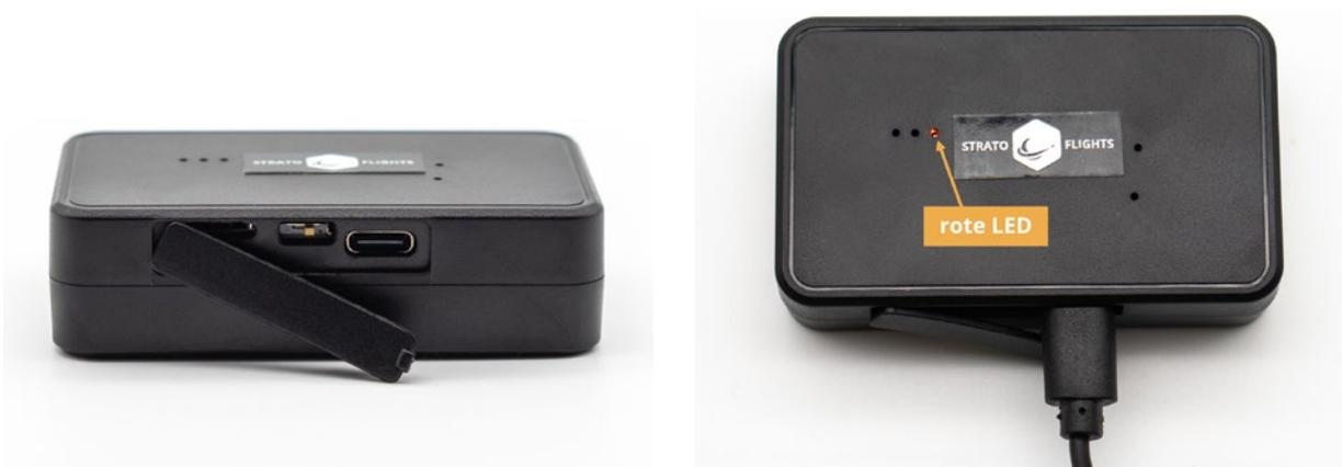
Nun kannst du vorsichtig das mitgelieferte USB-C-Kabel in den Anschluss stecken. Verbinde nun das USB-Kabel mit deinem Computer oder nutze den USB-Ladeadapter deines Smartphones. Ist der STRATOfinder korrekt mit der Stromquelle verbunden, lade diesen bitte so lange, bis die rote LED nicht mehr leuchtet.
